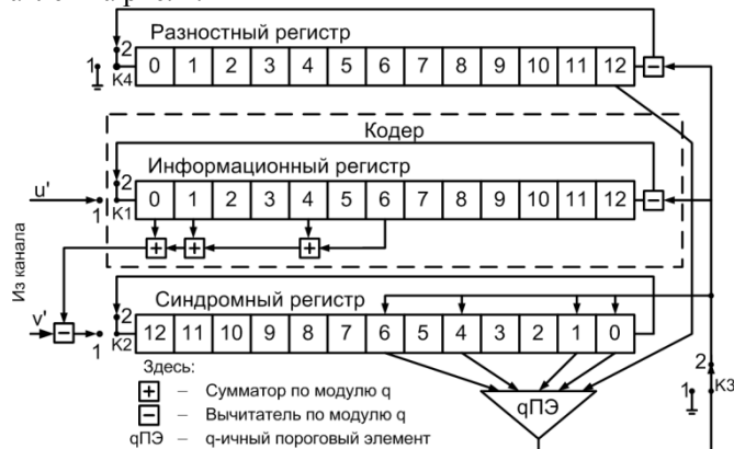
Рис. 2. q МПД для блокового q СОК
