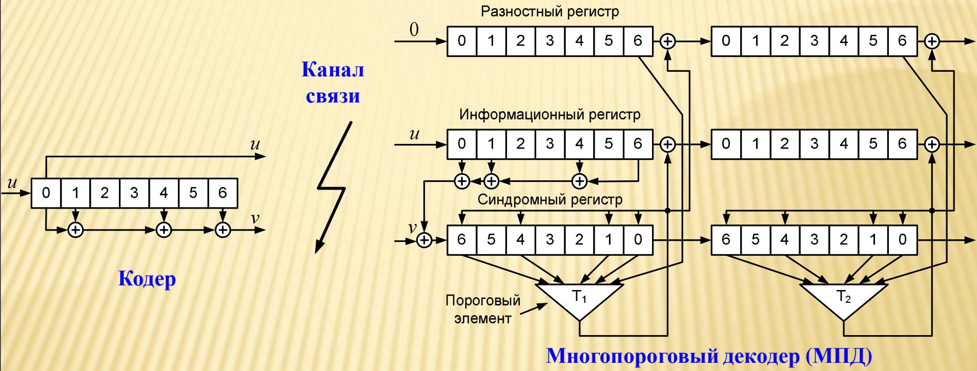
Многопороговый декодер является модификацией обычного порогового декодера Месси. МПД применяется для декодирования блоковых и сверточных двоичных и недвоичных самоортогональных кодов .
