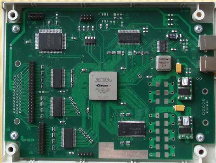
**Кодек МПД создан на базе ПЛИС Altera Stratix EP1S20 (стоимость ПЛИС < 400\$).
